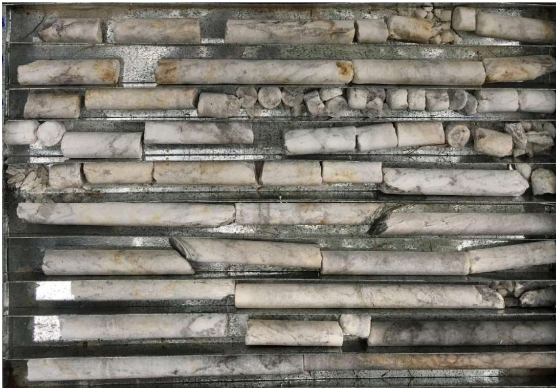
ภาพประกอบที่ 8) ภาพถ่ายแสดงแร่ยิปซัมที่พบจากหลุมเจาะ 16801/1 ที่ระดับความลึก 8 – 18 เมตร
