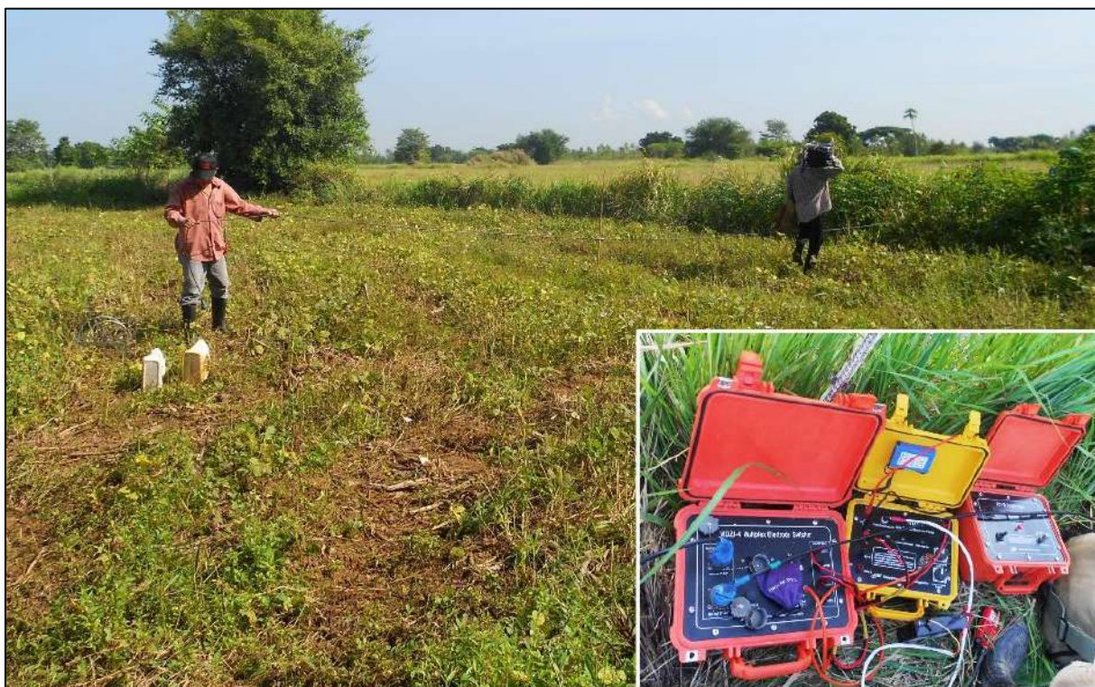
ภาพประกอบที่ 5) ภาพถ่ายแสดงการสำรวจธรณีฟิสิกส์ด้วยวิธีวัดความต้านทานไฟฟ้า บริเวณแนวสำรวจ H2 มองไปทางทิศเหนือ พิกัด 683954 E, 1763254 N
